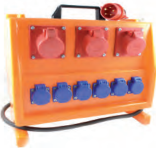
VERTEILER E-BOX 16 A / 3-6 Mobiler Stromverteiler mit Anschlußleitung 11 kVA Bestückung: 3 CEE-Dosen 16 A 5-polig 400 V, 6 x Schuko-Stecker 16 A 250 V
