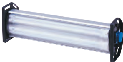
ALDEBARAN® 1000 2x36 W EVG EM Mobile Arbeitsleuchte mit Notlicht EVG - Vorschaltgerät, Gehäuse aus Aluminium, schlagresistente Acrylat-Scheibe, integrierte Notlichtfunktion, Steuermodul Zündzeit: 0,3 s.
